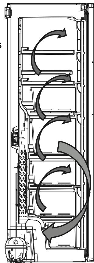
De situatie in No-Frost-diepvriezers is volledig anders. Door middel van een ventilator wordt droge en koude lucht vanuit verschillende punten homogeen in het vriesgedeelte geblazen. De koude lucht wordt homogeen en gelijkmatig tussen de schappen verspreid en koelt al uw levensmiddelen gelijkmatig en uniform, waardoor vochtigheid en bevriezing wordt voorkomen.
