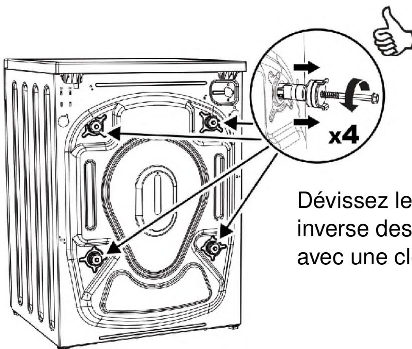
Dévissez les 4 vis dans le sens inverse des aiguilles d'une montre avec une clé appropriée.
