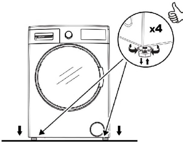
Les ouvertures de ventilation ne doivent pas être obstruées par un tapis (ou par une surface semblable).
