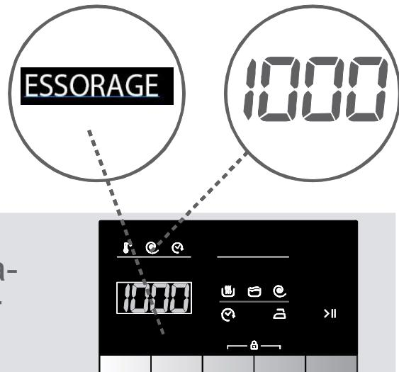
Vous pouvez progressivement réduire la vitesse de rotation en la faisant basculer entre les options (--) d'annulation de l'essorage et la rotation maximale de l'essorage du programme sélectionné en appuyant sur le bouton de réglage de la vitesse de rotation.
