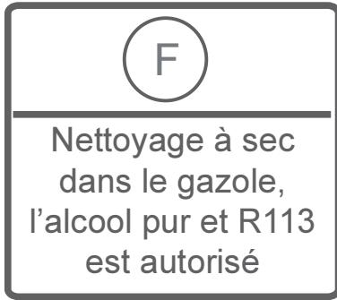
Nettoyage à sec dans le gazole, l'alcool pur et R113 est autorisé
