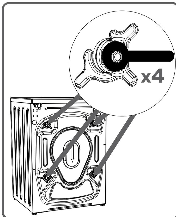
Retirez les vis en les faisant pivoter légèrement à gauche et à droite pour les retirer de leur emplacement.
