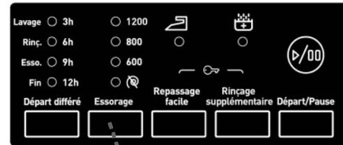
Vous pouvez progressivement réduire la vitesse d'essorage en appuyant sur le bouton de réglage de la vitesse d'essorage.
