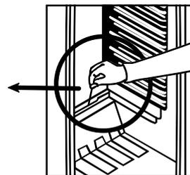
est recueillie dans le bac d'évaporation et s'évapore automatiquement. Le plateau d'évaporation et l'orifice d'évacuation de l'eau de dégivrage doivent être nettoyés régulièrement avec la tige de nettoyage du conduit de dégivrage pour éviter que l'eau ne s'accumule dans le bas du réfrigérateur.
