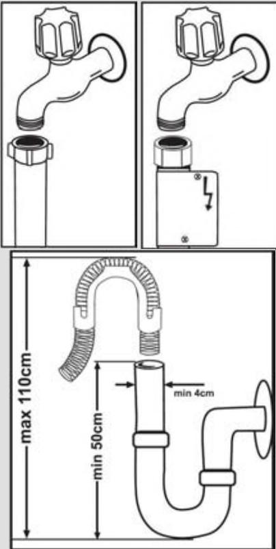
**NB** : Certains modèles utilisent un système Aquastop. Si votre lave-vaisselle est équipé de la fonction Aquastop, il y a du courant avec une tension dangereuse. Ne coupez pas l'embout Aquastop. Veillez aussi à ce qu'il ne soit pas plié ou tordu.
