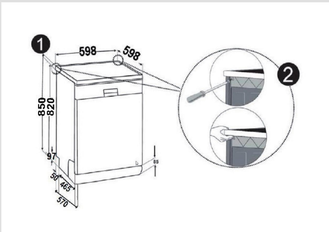
**Avertissement :** L'endroit où est installé le lave-vaisselle sans son top doit être stable afin d'éviter tout déséquilibre. Retirez le top du lave-vaisselle en dévissant les vis de fixation situées à l'arrière de l'appareil. Poussez ensuite le panneau frontal de 1 cm de l'avant vers l'arrière et soulevez-le.
