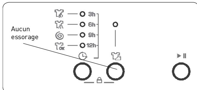
Pour annuler le cycle d'essorage prévu à la fin du programme sélectionné, appuyer sur la touche Aucun essorage jusqu'à ce que le symbole
