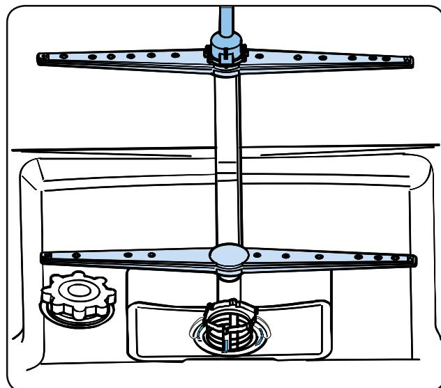
Pour enlever et nettoyer la combinaison du filtre, tournez cette dernière dans le sens inverse des aiguilles d'une montre et retirez-la en la soulevant (1). Retirez le gros filtre du micro filtre (2). Tirez le filtre métallique, puis retirez-le (3). Rincez le filtre en utilisant beaucoup d'eau jusqu'à ce qu'il n'y ait plus de résidus. Remettez les filtres ensemble. Replacez l'insert du filtre, et faites-le pivoter dans le sens des aiguilles d'une montre (4).
