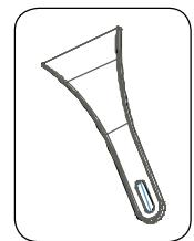
Utiliser la raclette en plastique fournie, si nécessaire. Pour ce faire, ne pas utiliser d'objets coupants en métal. Ils risqueraient de perforent le circuit du réfrigérateur et provoquer des dommages irréparables.
