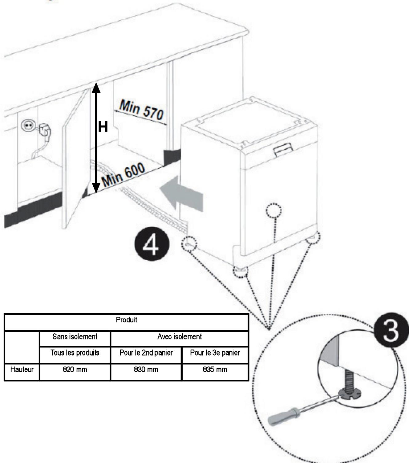
**Avertissement :** Une fois le plan de travail retiré, le lave-vaisselle doit être placé dans un endroit fermé dont les dimensions sont indiquées (Voir fig. 4)
