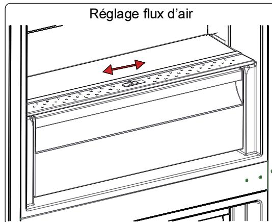
Si le compartiment à légumes est plein, le réglage flux d'air situé à l'avant du compartiment doit être ouvert. Ceci permet la pénétration de l'air dans le compartiment à légumes et le contrôle du taux d'humidité afin d'augmenter la durée de vie des aliments.
