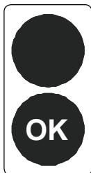
pastille noire devient alors verte foncée, laissant apparaître le « OK » en noir. Celui-ci est difficilement visible si l'indicateur de température est mal éclairé. La bonne lecture est facilitée s'il est correctement éclairé.
