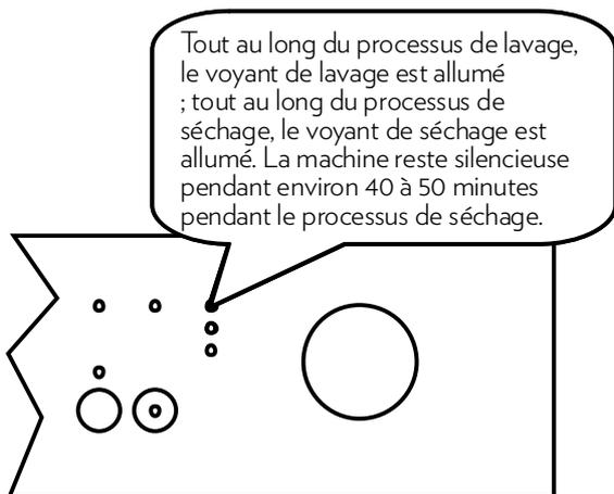
Tout au long du processus de lavage, le voyant de lavage est allumé ; tout au long du processus de séchage, le voyant de séchage est allumé. La machine reste silencieuse pendant environ 40 à 50 minutes pendant le processus de séchage.
