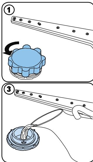
Pour ajouter du sel régénérant, ouvrez le couvercle du réservoir de sel en le tournant dans le sens anti-horaire. (1) (2) À la première utilisation, mettez 1 kg de sel et de l'eau (3) dans le réservoir jusqu'à ce qu'il déborde presque. Si possible, utilisez l'entonnoir (4) pour un remplissage plus facile. Replacez le couvercle et fermez-le. Après tous les 20 à 30 cycles, ajoutez du sel dans votre appareil jusqu'à en faire le plein (environ 1 kg).
