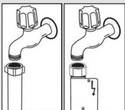
**NB :** Certains modèles utilisent un système Aquastop. Si votre lave-vaisselle est équipé de la fonction Aquastop, il y a du courant avec une tension dangereuse. Ne coupez pas l'embout Aquastop. Veillez aussi à ce qu'il ne soit pas plié ou tordu.
