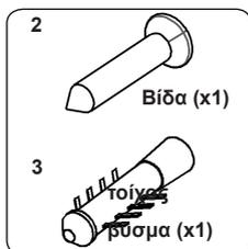
Η σακούλα εντύπων περιέχει ένα kit για τη σταθεροποίηση της συσκευής. Στερεώστε το στήριγμα σταθεροποίησης (1) στο έδαφος χρησιμοποιώντας τη βίδα (2) και το ούπατ (3) όπως φαίνεται στην παρακάτω εικόνα. Ρυθμίστε το ύψος του βραχίονα σταθεροποίησης έτσι ώστε να ευθυγραμμίζεται με την υποδοχή στην κουζίνα και σφίξτε τη βίδα. Σπρώξτε τη συσκευή προς το βραχίονα, βεβαιωθείτε ότι ο βραχίονας για την αποφυγή ανατροπής έχει εισαχθεί στην υποδοχή στο πίσω μέρος της συσκευής.
