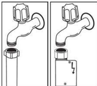
**NB** : Certains modèles utilisent un système Aquastop. Si votre lave-vaisselle est équipé de cette option, il y a du courant avec une tension dangereuse. Ne coupez jamais l'embout Aquastop et veillez à ce qu'il ne soit pas plié ou tordu.
