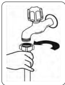
L'appareil doit être raccordé au réseau de distribution d'eau en utilisant les ensembles de raccordement neufs fournis avec l'appareil, il convient de ne pas réutiliser des ensembles de raccordement usagés.
