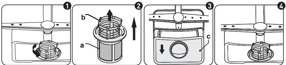
Pour enlever et nettoyer la combinaison des filtres, tournez cette dernière dans le sens inverse des aiguilles d'une montre et retirez-la en la soulevant (1). Retirez le gros filtre du micro filtre (2). Tirez le filtre métallique, puis retirez-le (3). Rincez le filtre en utilisant beaucoup d'eau jusqu'à ce qu'il n'y ait plus de résidus. Remettez les filtres ensemble. Remplacez l'insert du filtre, et faites-le pivoter dans le sens des aiguilles d'une montre (4).
