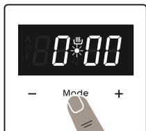
1. Appuyez sur « **MODE** » pendant 2 secondes pour désactiver le verrouillage des touches et le point au milieu de l'écran se mettra à clignoter.
