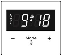
Lorsque la minuterie arrive à zéro, le four s'arrête et un signal sonore résonne. L'icône « A » clignote. Placez les deux boutons de commande sur « 0 » et appuyez
