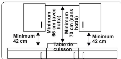
Cet appareil ne doit pas être installé directement au-dessus d'un lave-vaisselle, d'un réfrigérateur, d'un congélateur, d'un lave-linge ou d'un sèche-linge.
