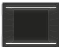
**Fonction Convection naturelle :** Le voyant du thermostat et la lampe témoin du four s'allument, et les résistances inférieure et supérieure commencent à
