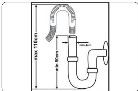
Raccordez le tuyau d'évacuation de l'eau directement à un trou d'évacuation de l'eau ou au siphon d'évacuation d'un évier. Ce raccordement doit être au minimum à 50 cm et au maximum à 110 cm du sol sur lequel est placé le lave-vaisselle.
