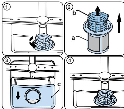
Pour enlever et nettoyer la combinaison des filtres, tournez cette dernière dans le sens inverse des aiguilles d'une montre et retirez-la en la soulevant (1). Retirez le gros filtre du micro filtre (2). Tirez le filtre métallique, puis retirez-le (3). Rincez le filtre en utilisant beaucoup d'eau jusqu'à ce qu'il n'y ait plus de résidus. Remettez les filtres ensemble. Replacez l'insert du filtre, et faites-le pivoter dans le sens des aiguilles
