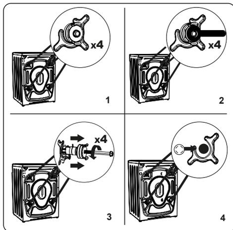
1. Avant de faire fonctionner le lave-linge, retirez les 4 boulons de transport et les entretoises en caoutchouc à l'arrière de l'appareil. Si les boulons ne sont pas retirés, ils peuvent provoquer de fortes vibrations, du bruit, un dysfonctionnement de l'appareil et la garantie serait annulée.
