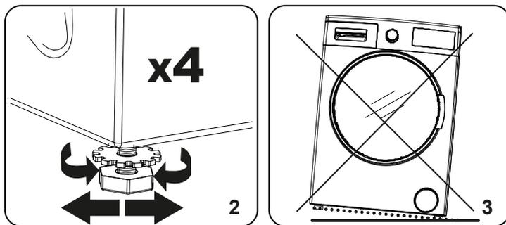
2. Pour rehausser l'appareil, tournez les pieds dans le sens des aiguilles d'une montre. Pour abaisser l'appareil, tournez les pieds dans le sens inverse des aiguilles d'une montre. Une fois que l'appareil est de niveau, serrez les écrous de blocage en les tournant dans le sens des aiguilles d'une montre.
