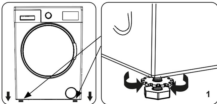
1. N'installez pas votre lave-linge sur une surface (telle qu'un tapis) qui pourrait empêcher la ventilation de la base de l'appareil. Pour garantir un fonctionnement silencieux et sans vibrations de votre appareil, installez-le sur une surface solide. Vous pouvez mettre de niveau votre appareil à l'aide des pieds réglables. Desserrez l'écrou de blocage en plastique.
