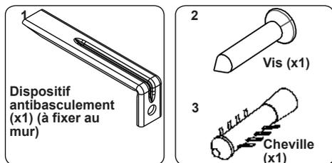
Le sac de documentation contient un kit antibasculement. Fixer le dispositif antibasculement (1) sur le mur à l'aide de la vis (2) et de la cheville (3), conformément aux dimensions de l'illustration et du tableau ci-dessous. Régler la hauteur du dispositif antibasculement pour l'aligner sur la rainure de la cuisinière, puis serrer la vis (2). Pousser l'appareil vers le mur en s'assurant que le dispositif antibasculement est inséré dans la rainure à l'arrière de l'appareil.
