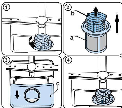
Pour retirer et nettoyer le bloc de filtrage, tournez-le dans le sens inverse des aiguilles d'une montre et retirez-le en le soulevant<sup>(1)</sup>. Sortez le filtre large du micro-filtre<sup>(2)</sup>. Puis tirez et ôtez le filtre métallique<sup>(3)</sup>. Rincez abondamment le filtre à l'eau jusqu'à ce qu'il n'y ait plus aucun résidu. Rassemblez les filtres. Replacez le bloc de filtrage, et faites le tourner dans le sens des aiguilles d'une montre<sup>(4)</sup>.
