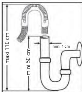
Raccordez le tuyau de vidange directement à l'évacuation d'eau ou au robinet de sortie d'eau du lavabo.
