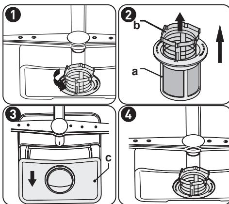
Pour retirer et nettoyer l'ensemble de filtration, tournez-le dans le sens inverse des aiguilles d'une montre et retirez-le en le soulevant vers le haut **1**. Retirez le filtre grossier du micro-filtre **2**. Puis tirez et retirez le filtre métallique **3**. Rincez le filtre avec beaucoup d'eau jusqu'à ce qu'il ne contienne plus aucun résidu. Remontez les filtres. Remettez l'ensemble de filtration en place et tournez-le dans le sens des aiguilles d'une montre **4**.
