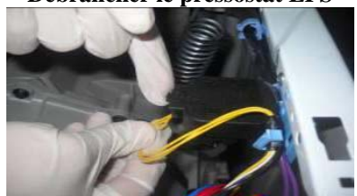
Débrancher le pressostat EPS
