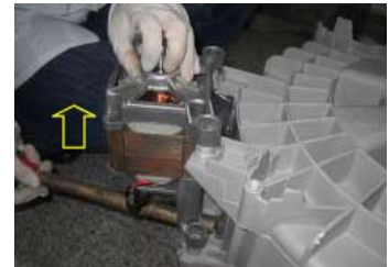
Démonter le moteur
