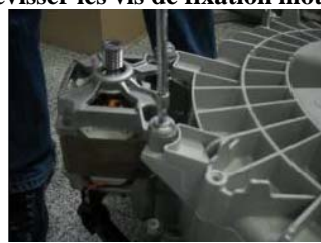
Dévisser les vis de fixation moteur
