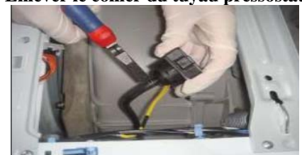
Enlever le collier du tuyau pressostat
