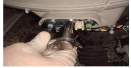
Démonter le collier joint de hublot
