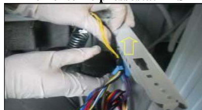
Démonter le pressostat EPS
