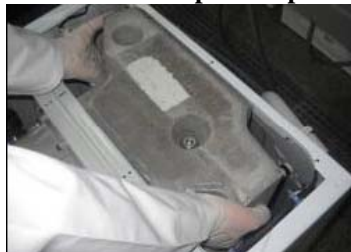
Démonter les 4 vis de la traverse supérieure
