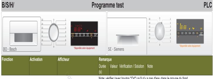
Note: vérifier (avec bouton "O4") qu'il n'y a pas d'eau dans le groupe du fond Note: verser environ 2,7 litres d'eau dans le bac de condensation
