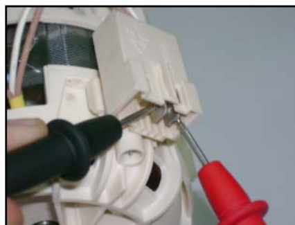
Mesure enroulement primaire 95 +/- 7
