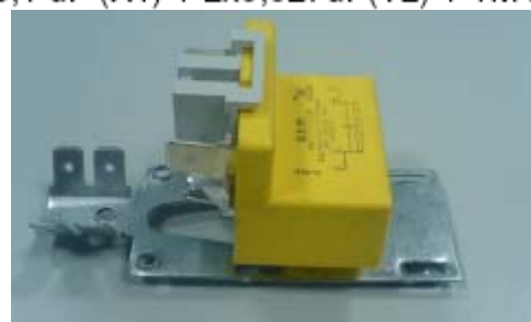
Condensateur Anti-parasite 0,1 uF (X1) + 2x0,027uF(Y2) + 1M Ω
