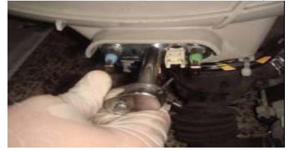
Démonter le collier joint de hublot
