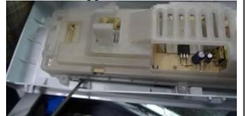
Appuyer sur les clips pour enlever l'ensemble touches
