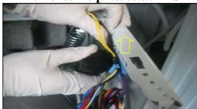
Démonter le pressostat EPS
