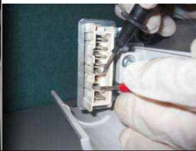
Mesure Stator (TAM SARGI)
