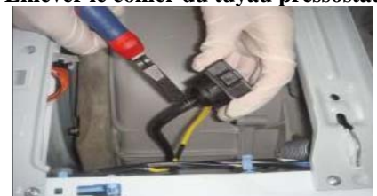
Enlever le collier du tuyau pressostat
