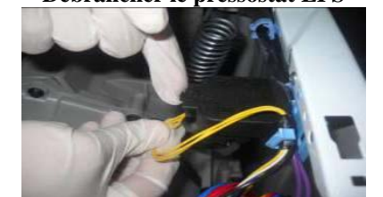
Débrancher le pressostat EPS
