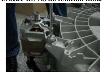
Dévisser les vis de fixation moteur
