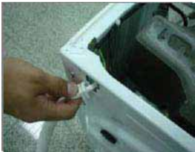
Débrancher le tuyau pressostat
