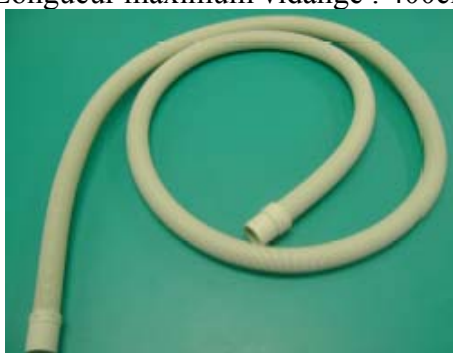
Tuyau de vidange Hauteur maxi vidange : 110cm Hauteur mini vidange : 50cm Longueur maximum vidange : 400cm
