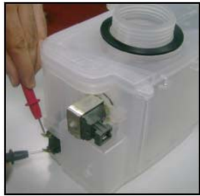
0 \Omega (sans sel) et \infty \Omega (avec sel)
