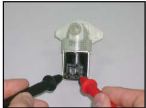
3750 \Omega \pm 10 (20°C) (BITRON ou TP)
