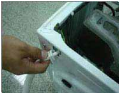
Débrancher le tuyau pressostat
