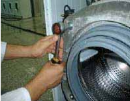
Démonter les axes des amortisseurs
