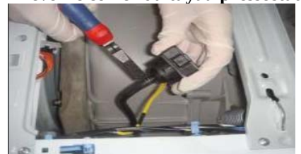
Enlever le collier du tuyau pressostat
