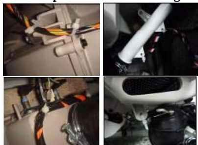
Enlever les clips de fixation amortisseur
