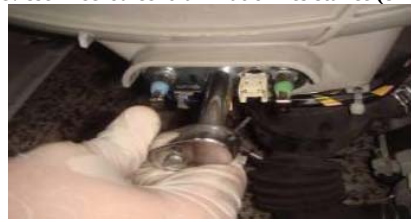
Démonter le collier joint de hublot
