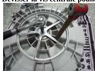
Démonter le moteur
