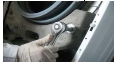
Dévisser l'écrou central fixation résistance (8mm)
