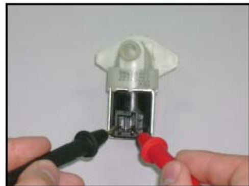
3750 \Omega \pm 10 (20°C) (BITRON ou TP)
