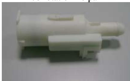
Condensateur Anti-parasite 0,1 µF (X1) + 2x0,027µF(Y2) + 1M Ω
