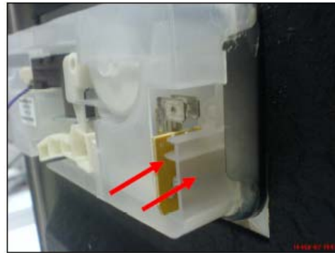
0 Ω (sans produit) et ∞ Ω (avec produit)
