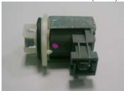
Electrovanne régénération 6W – 4130 ±10ohm (25C°)
