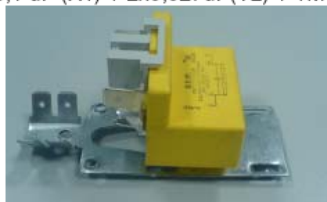
Condensateur Anti-parasite 0,1 µF (X1) + 2x0,027µF(Y2) + 1M Ω
