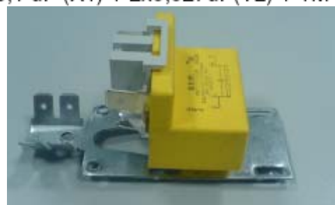
Condensateur Anti-parasite 0,1 uF (X1) + 2x0,027uF(Y2) + 1M Ω
