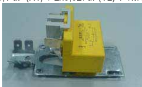
Condensateur Anti-parasite 0,1 uF (X1) + 2x0,027uF(Y2) + 1M Ω
