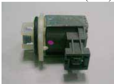
Electrovanne régénération 6W – 4130 ±10ohm (25C°)
