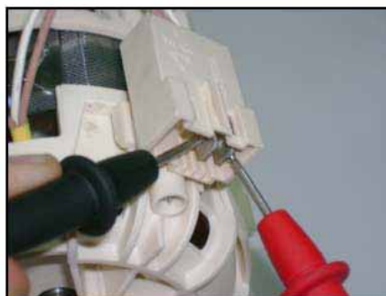
Mesure enroulement primaire 95 +/- 7
