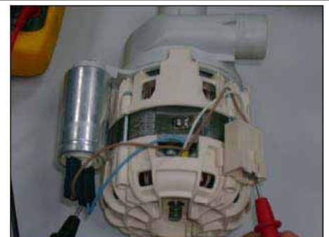
Mesure enroulement secondaire (câble bleu) 126 +/- 7
