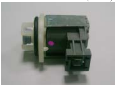
Electrovanne régénération 6W - 4130 ±10ohm (25C°)
