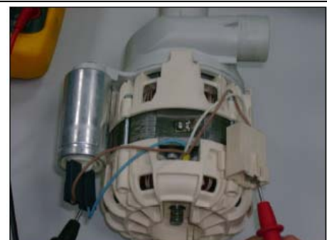
Mesure enroulement secondaire (câble bleu) 126 +/- 7
