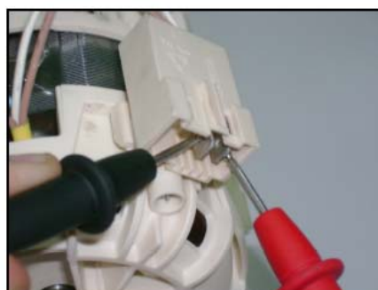
Mesure enroulement primaire 95 +/- 7
