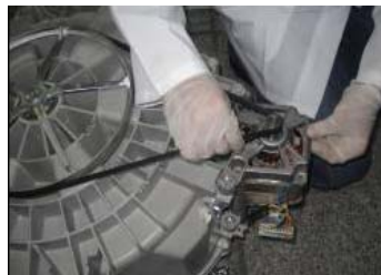
Dévisser les vis de fixation moteur
