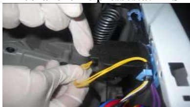
Débrancher le pressostat EPS
