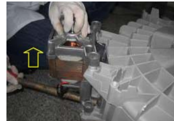
Démonter le moteur
