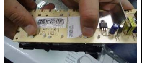
Appuyer sur les clips pour enlever l'ensemble touches
