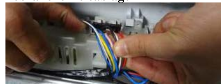
Débrancher le câblage
