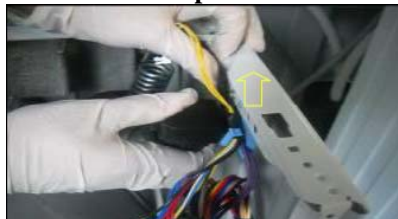
Démonter le pressostat EPS
