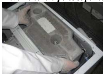
Démonter les 4 vis de la traverse supérieure
