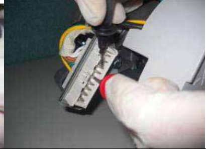
Mesure Stator (YARIM SARGI)
