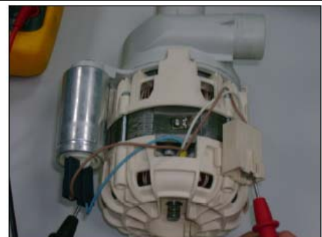
Mesure enroulement secondaire (câble bleu) 126 +/- 7
