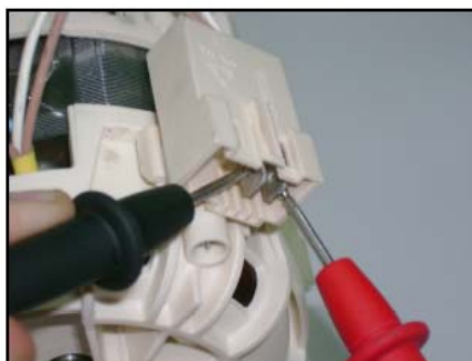
Mesure enroulement primaire 95 +/- 7
