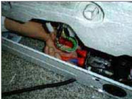
Débrancher la résistance
