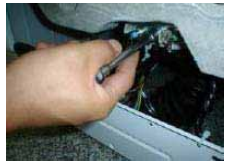
Démonter la résistance
