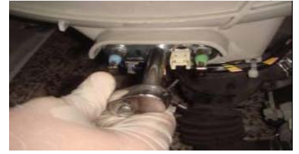
Démonter le collier joint de hublot
