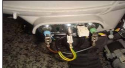
Démonter le collier joint/cuve
