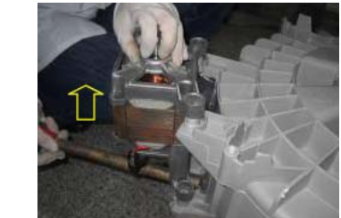
Démonter le moteur
