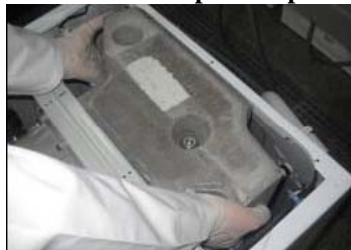
Démonter les 4 vis de la traverse supérieure
