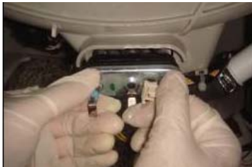
Dévisser les vis du contre-poids supérieur
