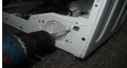
Débrancher la résistance
