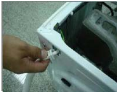
Débrancher le tuyau pressostat
