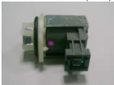
Electrovanne régénération 6W - 4130 ±10ohm (25C°)
