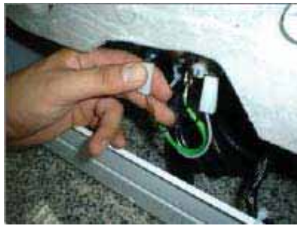
Débrancher la résistance
