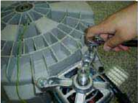
Démonter le moteur
