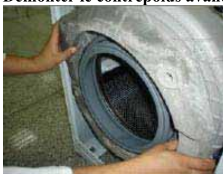
Dévisser les vis du contrepoids supérieur
