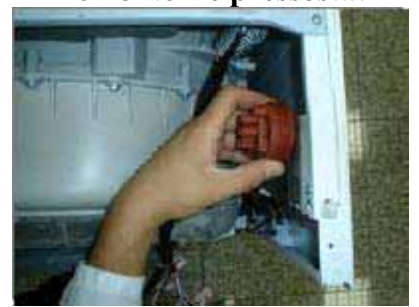
Débrancher la sécurité de porte
