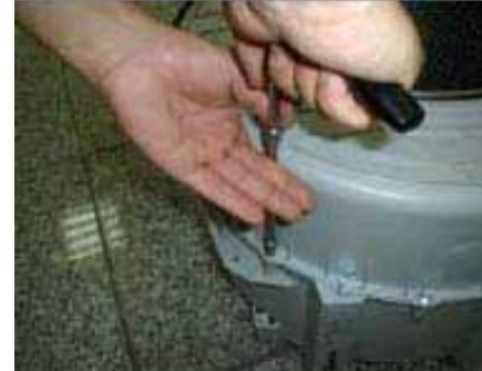
Démonter la cuve
