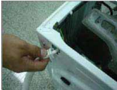
Débrancher le tuyau pressostat
