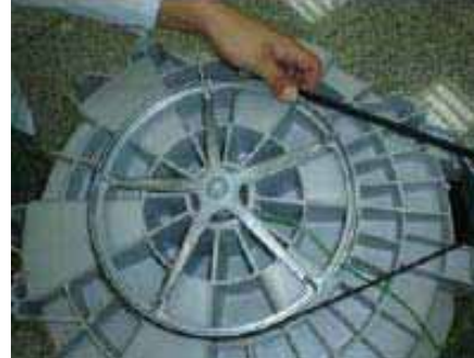
Démonter la cuve
