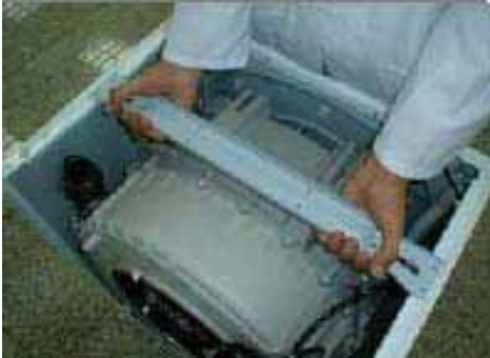
Démonter le moteur
