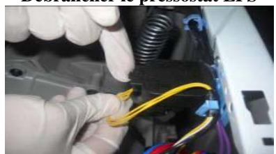
Débrancher le pressostat EPS
