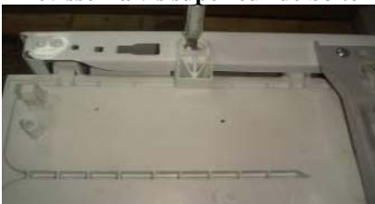
Démonter les 2 vis de l'anti-parasite
