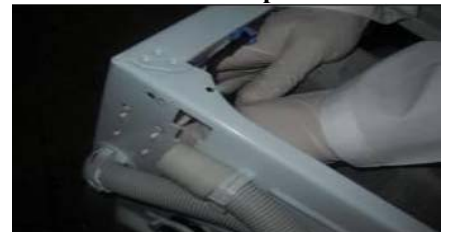
Enlever le collier du tuyau pressostat
