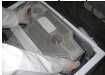
Démonter les 4 vis de la traverse supérieure
