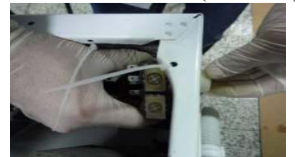
Débrancher le filtre anti-parasite
