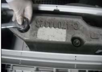
Couper les fixations câblage
