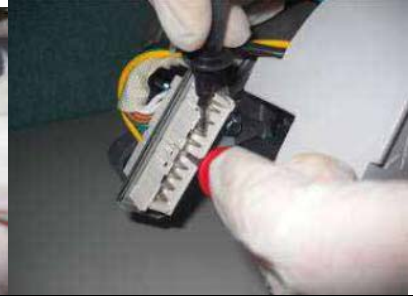
Mesure Stator (YARIM SARGI)
