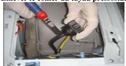
Enlever le collier du tuyau pressostat
