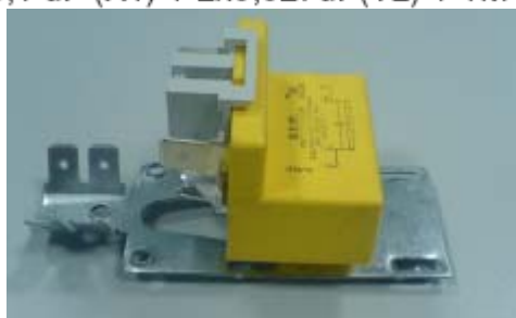
Condensateur Anti-parasite 0,1 uF (X1) + 2x0,027uF(Y2) + 1M Ω
