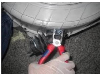
Retirez le tuyau du soufflet d'admission de la cuve en desserrant le collier en le serrant à l'aide d'une pince.
