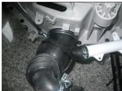
Retirez le tuyau de soufflet de la sortie de la cuve en desserrant la vis du collier.
