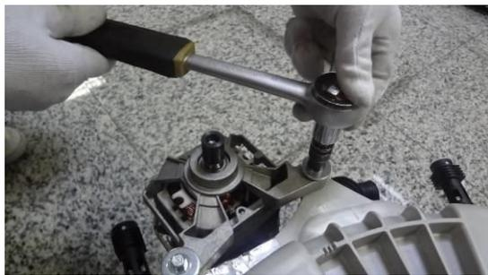
Retirez les deux vis qui retiennent le moteur à l'aide d'une clé à douille.
