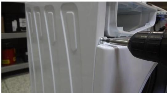
Retirez les deux vis fixant le panneau frontal au châssis.
