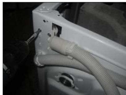
Retirez les 2 vis de fixation du filter EMI.
