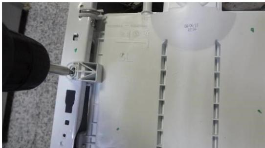
Retirez les deux vis fixant le groupe châssis sur la partie supérieure
