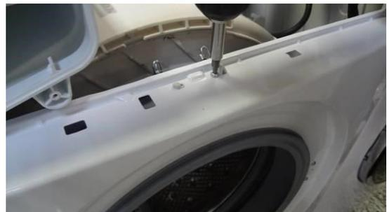
Retirez la vis de fixation du coude du double jet.
