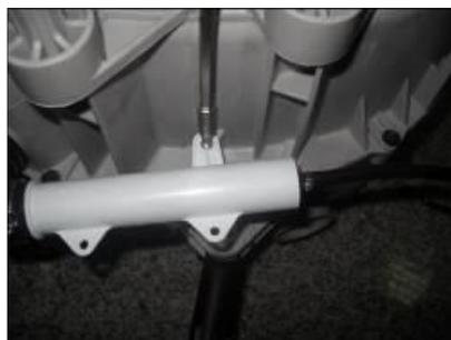
Retirez la vis maintenant le réservoir d'EPS
