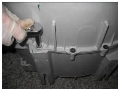
Retirez les 19 vis autour de la cuve à l'aide d'une clé de 8 mm.
