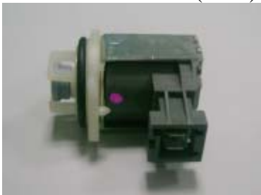
Electrovanne régénération 6W - 4130 ±10ohm (25C°)
