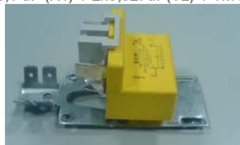
Condensateur Anti-parasite 0,1 uF (X1) + 2x0,027uF(Y2) + 1M Ω
