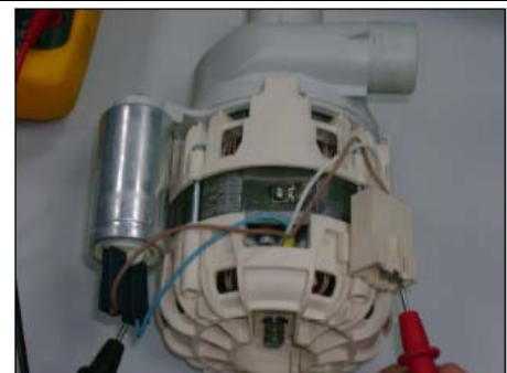
Mesure enroulement secondaire (câble bleu) 126 +/- 7
