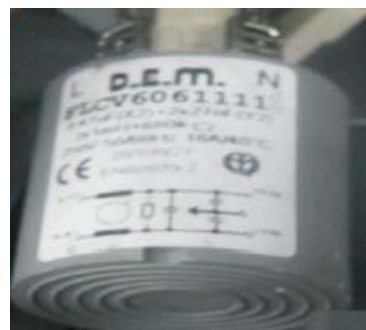
Filtre antiparasite 0,1 \mu\text{F} (X1) + 2 \times 0,027 \mu\text{F} (Y2) + 1 \text{M} \Omega
