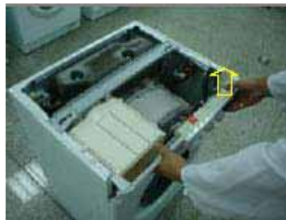
Dévisser les vis de plinthe
