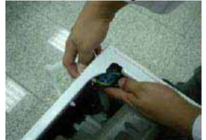
Démonter le pressostat
