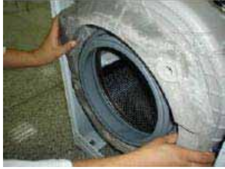
Dévisser les vis du contrepoids supérieur
