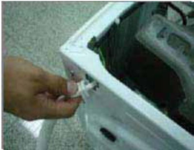
Débrancher le tuyau pressostat
