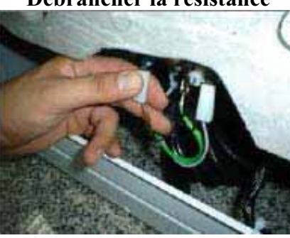
Débrancher la résistance
